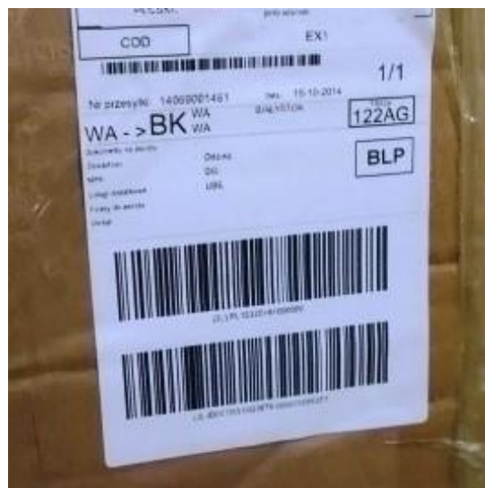
Zbyt wysoka temperatura wydruku ( kod wypalony, skleiony )
