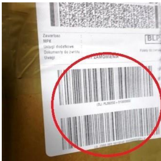
Zbyt niska temperatura wydruku ( kod wyblakły )
